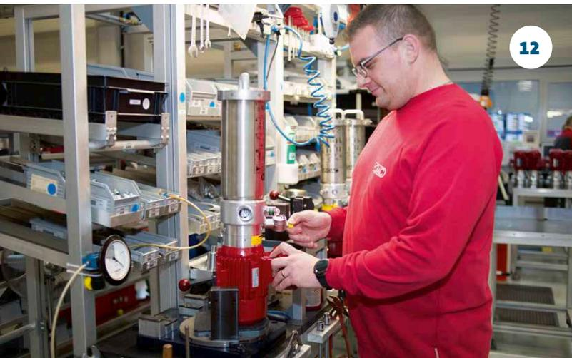
**12 — Ein Hydac-Mitarbeiter prüft ein hydraulisches Nebenstromfilteraggregat vor der Endabnahme.**
